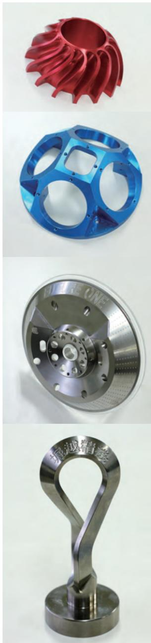
5つの方向から加工が可能な5軸制御マシニングセンターで加工したサンプル。上から、スクリュー、プラネタリウムの部品、エンジン部品、オブジェ。
