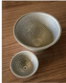
表面の凸凹の模様もすべて金型から再現できる。
