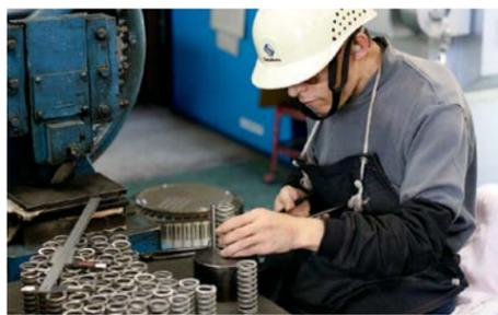
冷間成形は、あらかじめバネの機械的特性を持たせた材料を使ってバネをつくる。
