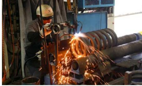
大型のコイルバネの端を水平にするために両端を切り取る作業。
