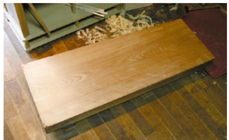
水平を決めるのがアテ台。すべての作業をこの上で行う。正月の仕事始めはまず、アテ台にカンナをかけることから始まる。
