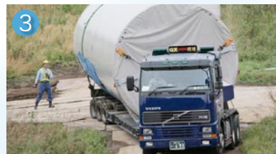
分解されたタワー部分を大型トレーラーで移送
