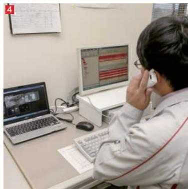
1 四国情報通信所の無線中継局。対向局からの送信電波を2つのアンテナで受信する方式で通信品質を高めている。2 瀬戸内海を隔てた児島ケーブルヘッド（岡山県倉敷市）へ出向き、通信設備の作動状況に目を光らす。3 マイクロ波無線機や光端局装置などを入念にチェック。4 管轄エリア内の情報通信設備を、運用データとライブカメラ映像により24時間体制で監視できる。5 所内でのミーティング。遠隔地とはTV会議も行うが、現地には積極的に足を運ぶという。
