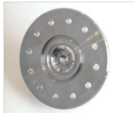
ロケットエンジンのインジェクター（電子式燃料噴射装置）の部品。材料はインコネル。
