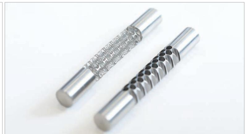
ニッケル合金であるインコネルを16時間かけて掘削したインコネルメッシュ（左）。切削加工のコンテストで金賞を受賞。右は1工程目の状態。
