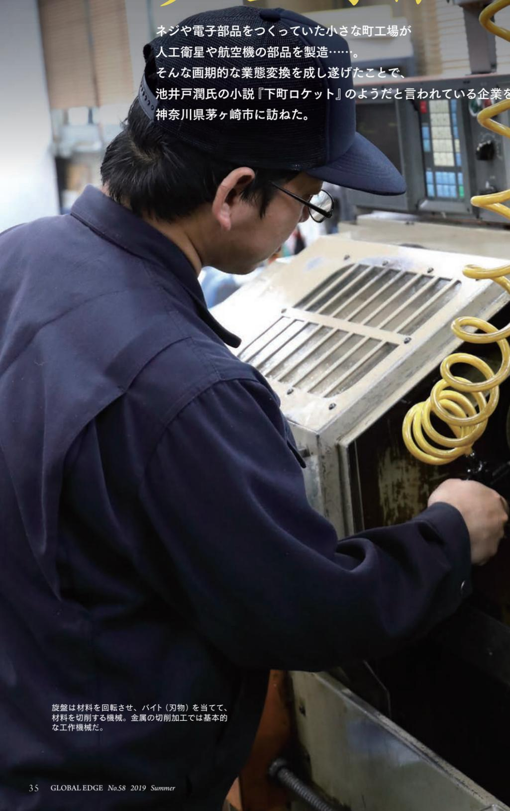
旋盤は材料を回転させ、バイト（刃物）を当てて、材料を切削する機械。金属の切削加工では基本的な工作機械だ。
