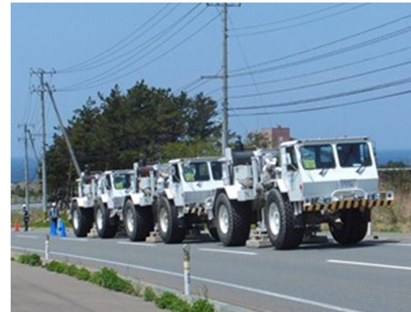
図4 弾性波探査②の調査の状況(事例)
