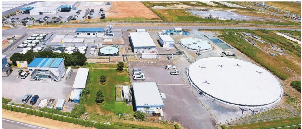
若松研究所にあるオープン/クローズ型ハイブリッド培養技術開発に活用する直径40m培養装置（600m<sup>2</sup>クラス）を含む培養設備の全体配置
