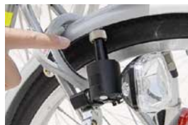
スタンドを立てたままでも 発電するように、前輪につ いている発電機を 後輪にセット。
