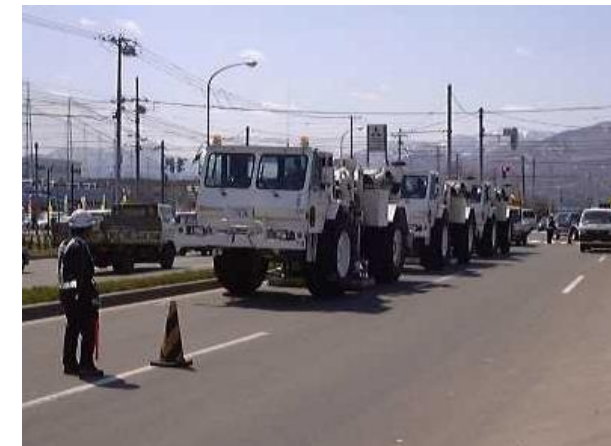
図3 起振車による発振状況(事例)
