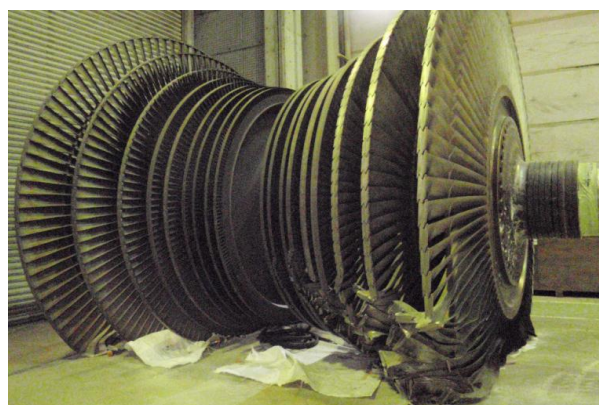
【損傷した低圧タービンロータ】
