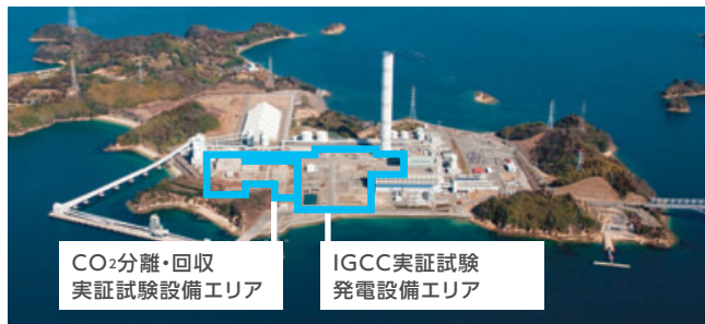
大崎クールジェン実証試験設備配置図 (中国電力株式会社大崎発電所構内/広島県)
