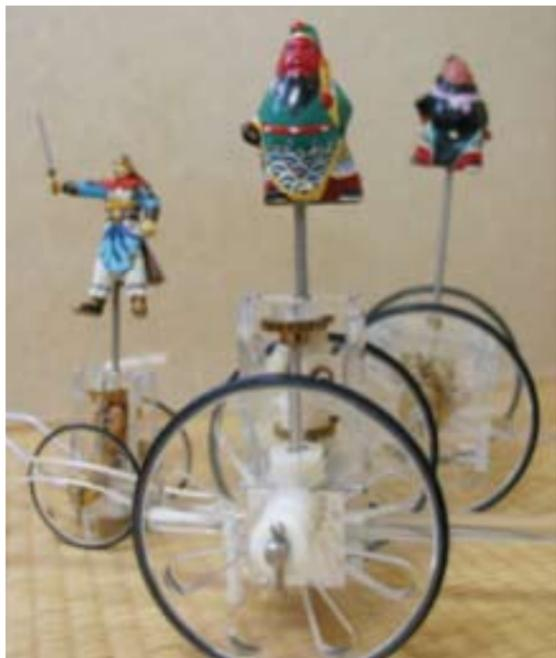
中国で有史以前に発明されたとされる「指南車」の模型。車の上の仙人が常に南を指し示す。大野精密では7種類のギアの組み合わせで製作した。自動車のデファレンシャルギアの原型。\*人形は仮のサンプルです。
