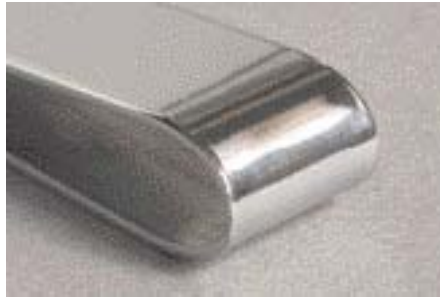
ダイクロンは折り曲げてでも剥離しない。
