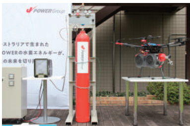
褐炭由来水素を充てんしたホンベと燃料電池(中央)、水素燃料電池搭載ドローン(右)
